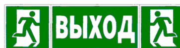
Конечный эвакуационный выход (при наличии двух направляющих линий в коридорах шириной более 2 м и помещениях большой площади) 1)
